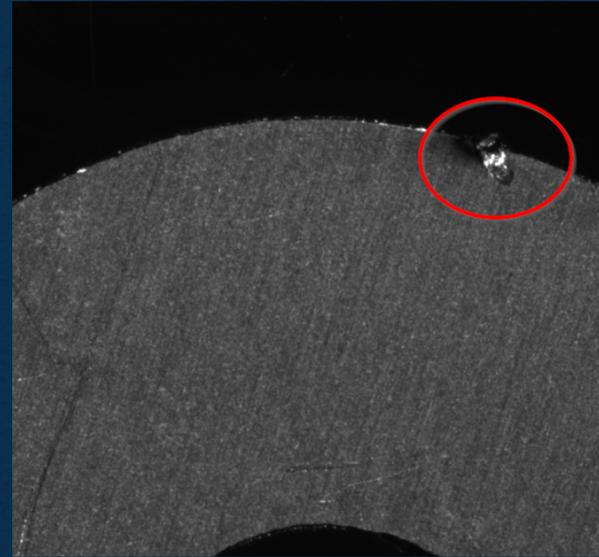
На кромке присутствуют заусенцы от лазерной резки.
