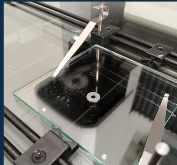
Измерения проводились на оборудовании Zeiss O-Inspect в фиксированном состоянии.
